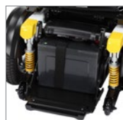
Baterías con capacidad de 75Ah. 75Ah batteries capacity.
